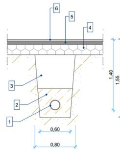
1. Condotta fognante in PVC  $\varnothing$  200mm
