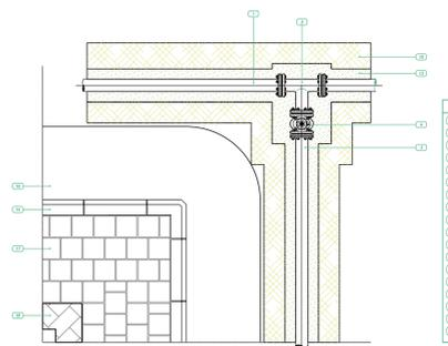
Derivazione da condotta adduttice con saracinesca d'intercettazione sottosuolo
